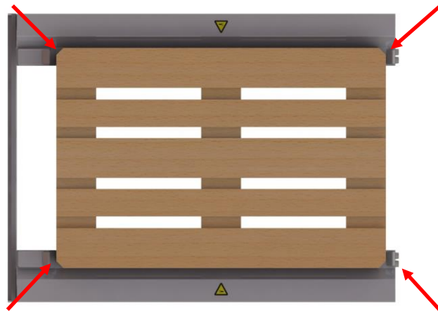
Abbildung 12 Platzieren der Palette auf der Palettenstation
